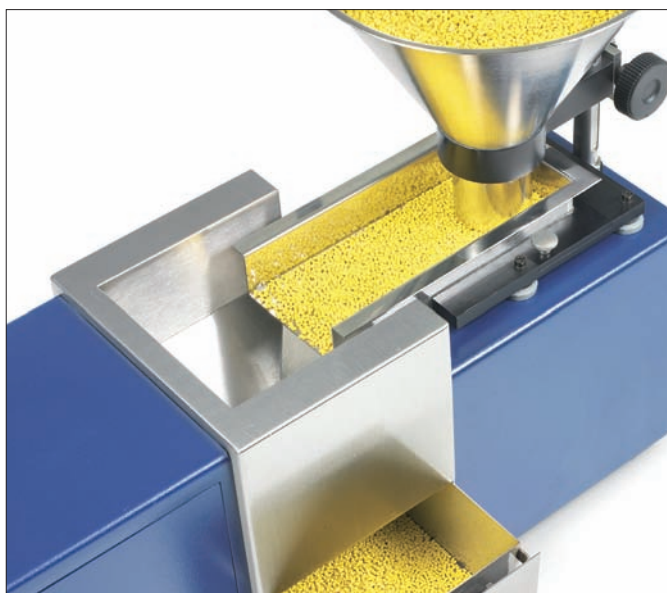
HAYER CPA 3-2 bei der Vermessung von Kunststoffgranulat
